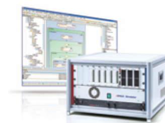
図3 dSPACE Mid-Size HILS および AutomationDesk
